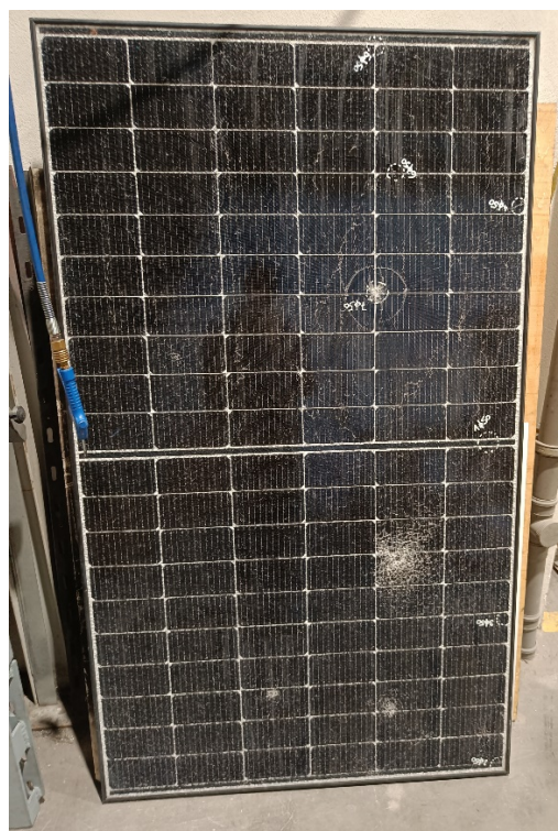
PV-Panel nach Überprüfung der Hagel-Widerstands-Klasse
